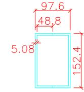
PLANTA - PILAR METÁLICO
